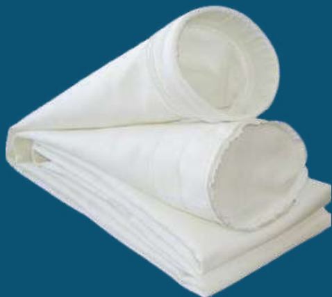
MANCHES 5"X3M EN FEUTRE POLYESTER AVEC MEMBRANE PTFE
